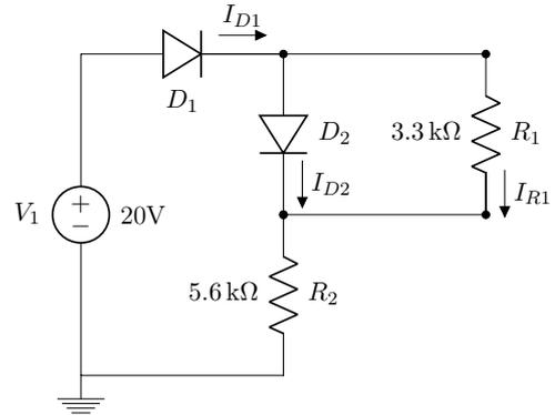
Calcule  $I_{D1}$ ,  $I_{D2}$  e  $I_{R1}$ , assumindo modelo de bateria de 0.7 V para os diodos.
