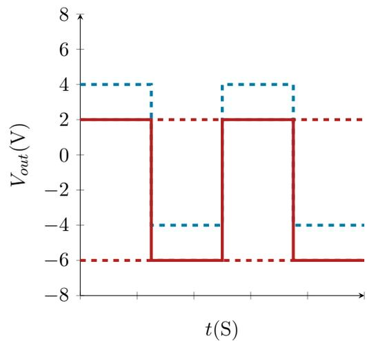
Na entrada, temos  $V_{DC} = 0$ . Na saída, temos  $V_{DC} = -2$ . Agora a relação estática entre  $V_{in}$  e  $V_{out}$  em diferentes instantes de tempo  $t$ .
