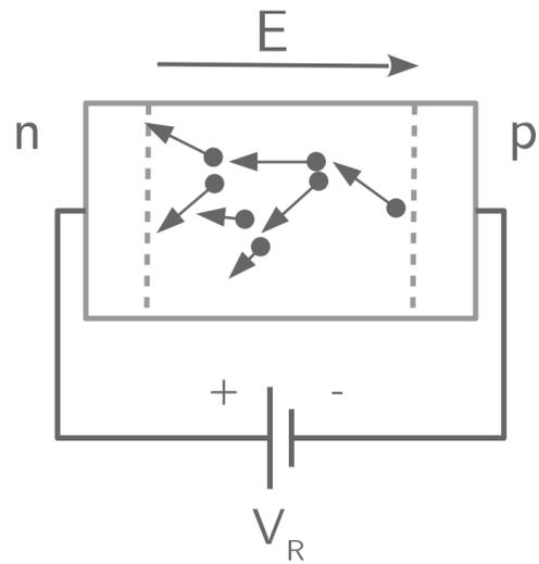
Breakdown reverso por efeito avalanche. Níveis de dopagem moderados ou baixos (inferiores a  $10^{15}/\text{cm}^3$ ); "ionização de impacto", dentro da região de depleção; TC (coeficiente de temperatura positivo).
