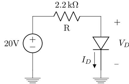
Solução pelo método "iterativo", consiste em alternar entre a equação que descreve o circuito a ser analisado e a equação exponencial do diodo.
