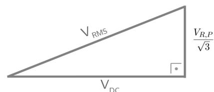
(\*) A definição de tensão de "ripple"(ondulação) facilita o cálculo de  $V_{AC,RMS} = \frac{V_{R,P}}{\sqrt{3}}$  no caso da forma de onda "dente de serra", mas é possível fazer também o cálculo "direto"(mais trabalhoso):
