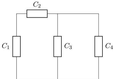
Um circuito pode apresentar também as duas configurações, no circuito acima,  $C_1$  está em série com  $C_2$  já  $C_3$  e  $C_4$  estão em paralelo, mas olhando os dois conjuntos,  $C_1$  e  $C_2$  estão em série com a associação de  $C_3$  e  $C_4$ .
