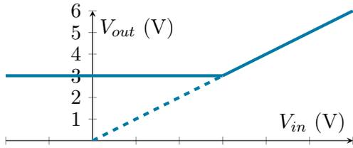
Este gráfico representa uma "relação estática" de transferência entre  $V_{in}$  e  $V_{out}$ . Usamos a palavra "estática" para frisar que  $V_{out}$  só depende de  $V_{in}$  no instante  $t$  atual, para qualquer  $t$ . E não da função  $V_{in}(t)$ .
