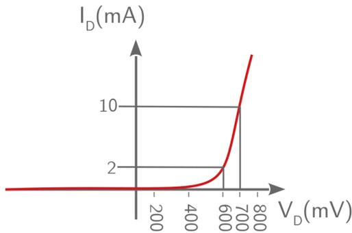
"Linearização" em torno do ponto  $V_D = 0.7\text{ V}$ ,  $I_D = 10\text{ mA}$ :
