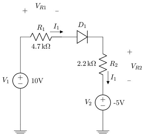
Calcule as voltagens  $V_{R1}$  e  $V_{R2}$ , usando os modelos de diodo a seguir:
