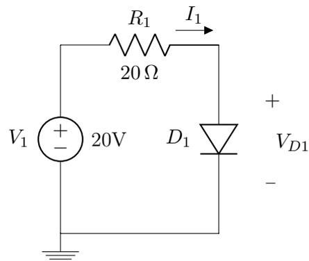
Calcule a corrente  $I$ , usando os modelos de diodo a seguir:
