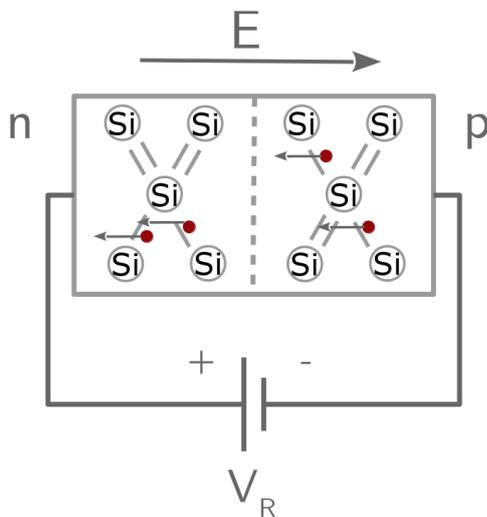
Breakdown reverso por efeito Zener.  $10^6 \text{ V/cm}$ ; região de depleção mais estreita; níveis mais altos de dopagem, nos dois lados da junção. Voltagem reversa na faixa de 3 V a 8 V; TC negativo.
