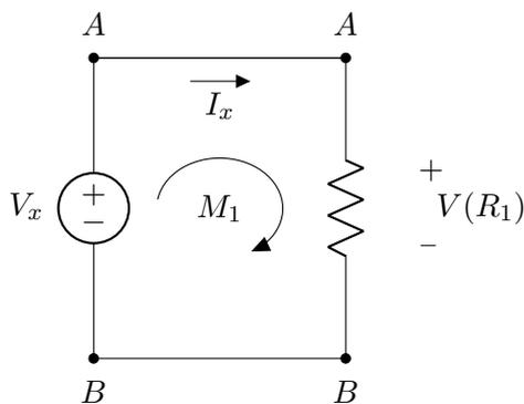
Como elementos em paralelo tem a mesma voltagem entre seus terminais, qualquer componente em paralelo com uma fonte de tensão terá uma mesma tensão.
