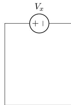
Onde  $V_x = V_1 + V_2 - V_3$  já que  $V_1$  e  $V_2$  estão no mesmo sentido de  $V_x$  e  $V_3$  está no sentido contrário.
