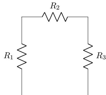
Resistores em série podem ser associados de modo que possam ser substituídos por um único resistor de resistência equivalente que pode ser calculada por:
