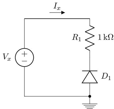
**17 )** Faça um gráfico da relação  $I_x \times V_x$  da figura a seguir. Para o diodo zener, use o modelo com baterias constantes:
