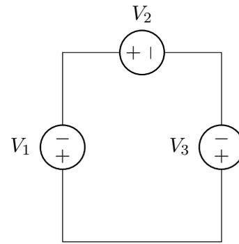
Analogamente a resistores, fontes de tensão em série podem ser associadas somando as tensões em cada uma e substituindo por uma equivalente. No entanto, deve-se prestar atenção aos seus sentidos. O circuito acima pode ser redesenhado desta forma:
