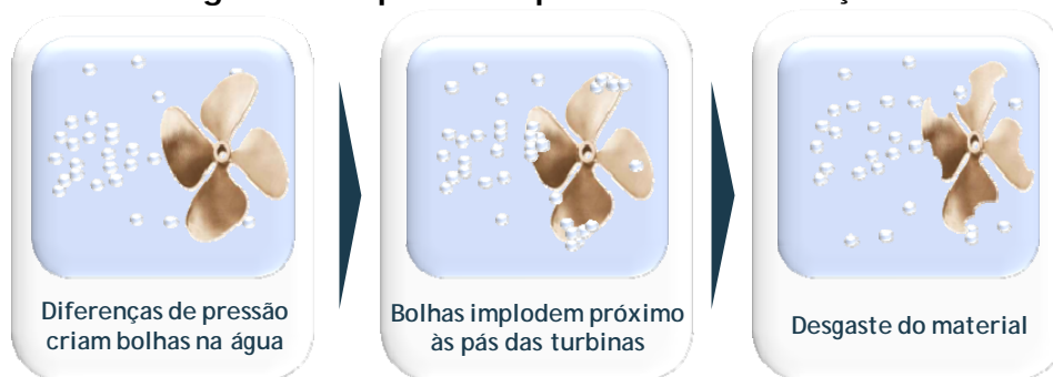
Figura 2: Esquema do processo de cavitação
