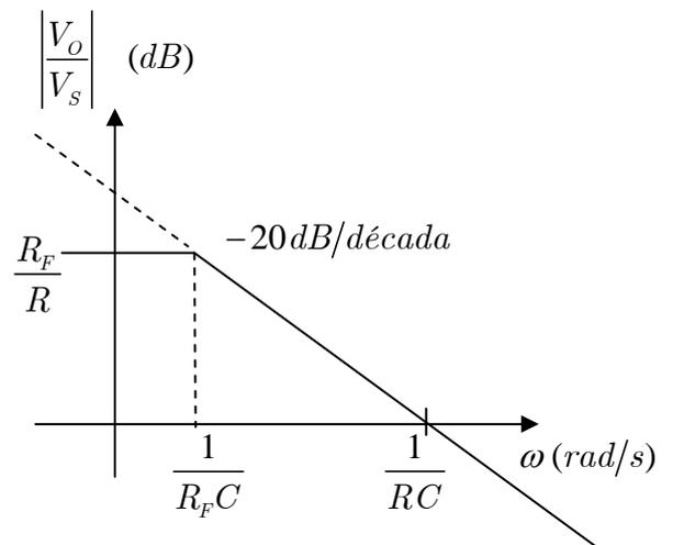
para  $\omega \gg 1/R_F C$ , o circuito se comporta como integrador ideal:
