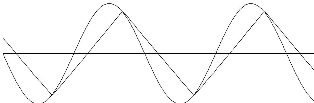
À medida que aumenta a amplitude ou a frequência do sinal senoidal de saída, aumenta a taxa de subida necessária para reproduzir o sinal sem ocorrer distorção. Assim, para não haver distorção, o SR deve ser maior do que a taxa de subida do sinal senoidal de saída.
