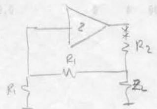
$$\frac{U_r}{U_f} = \frac{1}{Z} \frac{2R_1 \parallel Z_L}{R_2 + 2R_1 \parallel Z_L} \times Z < 1 \Rightarrow \text{estável.}$$
