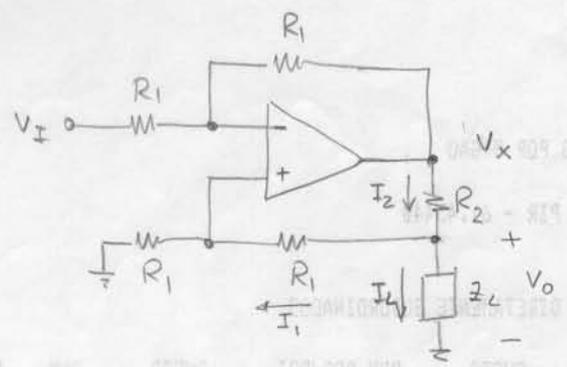
o amp-op atua como um amplificador diferencial com entradas  $V_0$  e  $V_I$ !
