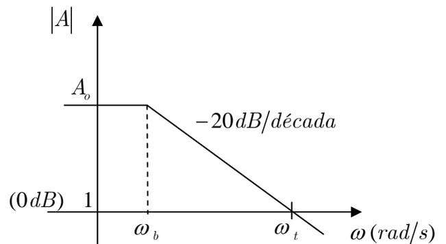
Para  $\omega \gg \omega_b$ , e considerando que  $\omega = 2\pi f$ ,  $\Rightarrow |A(j\omega)| \approx \frac{A_o \omega_b}{\omega} = \frac{A_o f_b}{f}$
