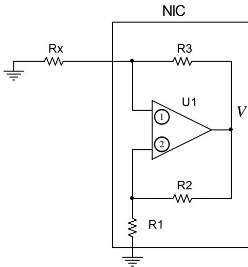
$$V_{\oplus} = V \frac{R_x}{R_x + R_3}$$
