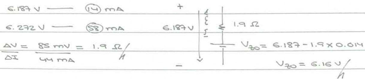
Exemplo de aplicação do modelo (com  $V_{Z0} = 6.16 \text{ V}$  e  $r_Z = 1.9 \Omega$ ) ao caso
