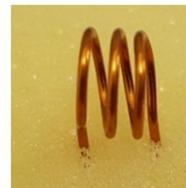
Indutor de núcleo de ar e fio rígido.
