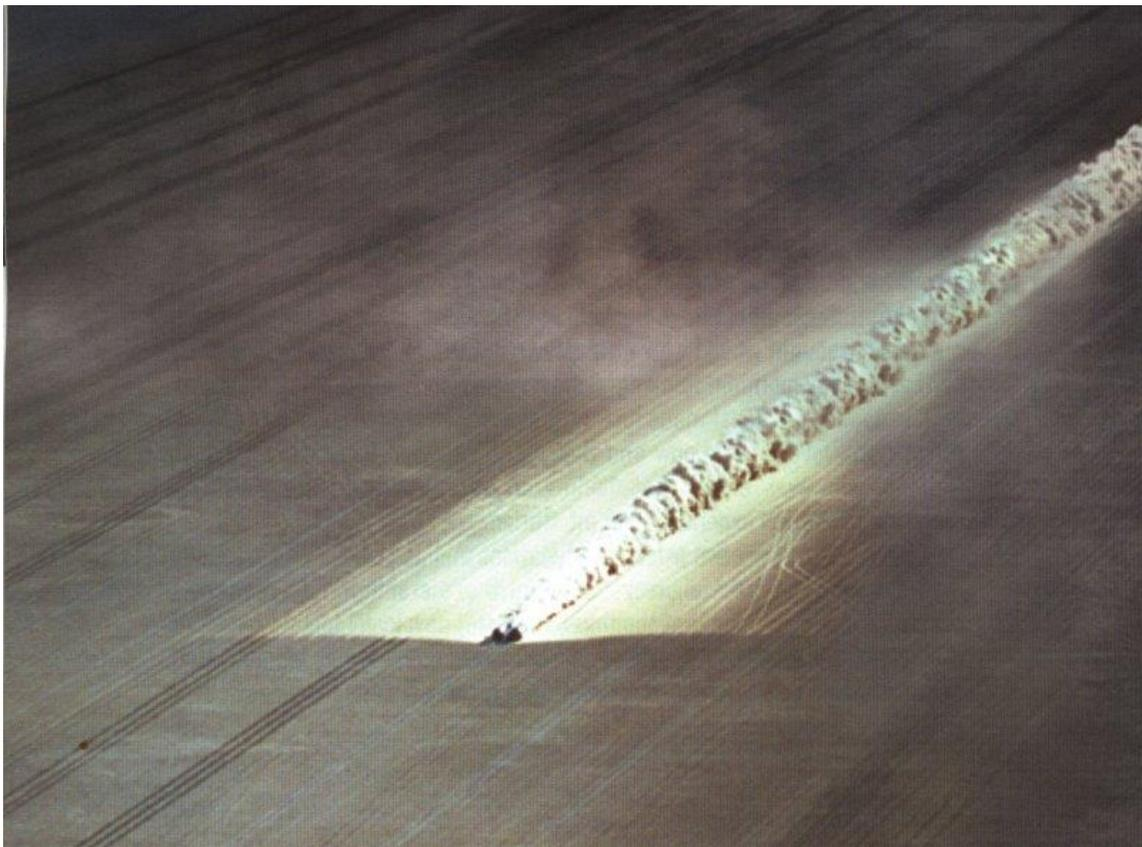
Figura 39 - ThrustSSC próximo a quebrar a Barreira do Som, esta pode ser vista na linha frontal ao carro [74]
