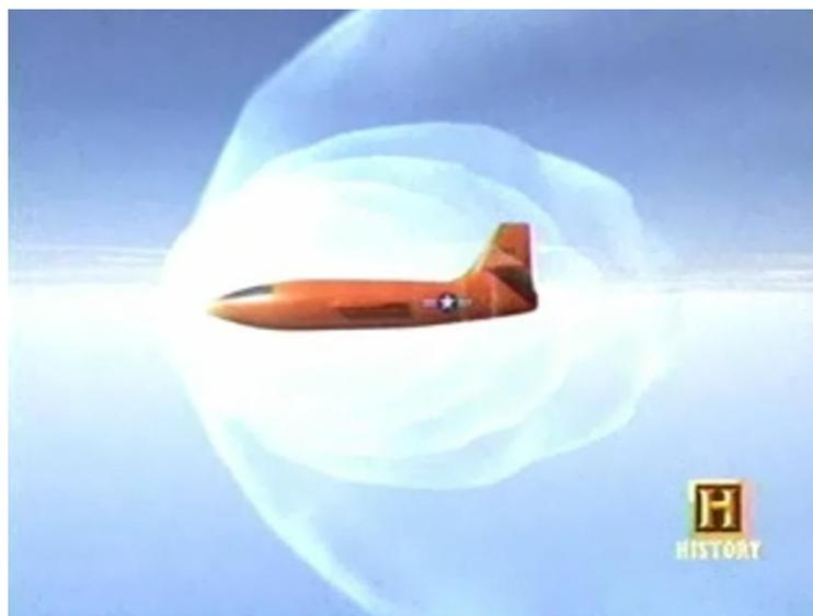
Figura 1 - Ondas de pressão concentrando-se na frente de um avião [4]
