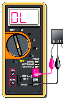
Teste de polarização reversa da junção BE
