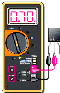
Teste de polarização direta da junção BE
