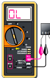
Teste de polarização reversa da junção BE
