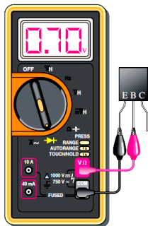
Teste de polarização direta da junção BE
