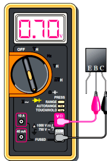
Teste de polarização direta da junção BC
