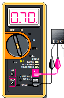
Teste de polarização direta da junção BE
