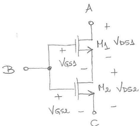
$$V_{DS2} = V_{GS2} - V_{GS1}$$
