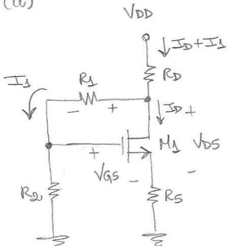
Em virtude da queda de tensão em  $R_D$  causada pela corrente  $I_S$ , temos que  $V_{DS} = V_{GS} + R_D I_S$ . Logo, certamente teremos que  $V_{DS} > V_{GS} - V_{th}$  e, consequentemente, podemos afirmar que  $M_1$  está na saturação.
