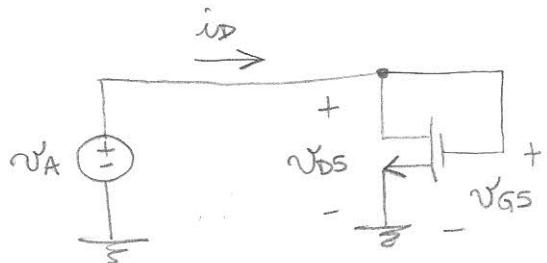
Já para  $V_A > V_{th}$ , o transistore certamente estará operando na saturação, nisso:
