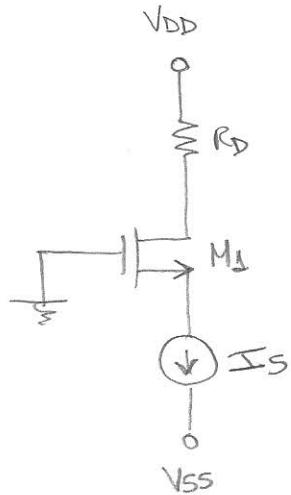
Nesse esquema, a corrente de polarização DC é estabelecida diretamente pela fonte de corrente I\_S. Assim:
