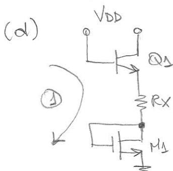
Nesse circuito o Transistor  $M_1$  apresenta  $V_{DS} = V_{GS} \cdot 2,0 \text{ V}$ , temos que  $V_{DS} > V_{GS} - V_{th}$ , o que garante a sua operação no modo de saturação.
