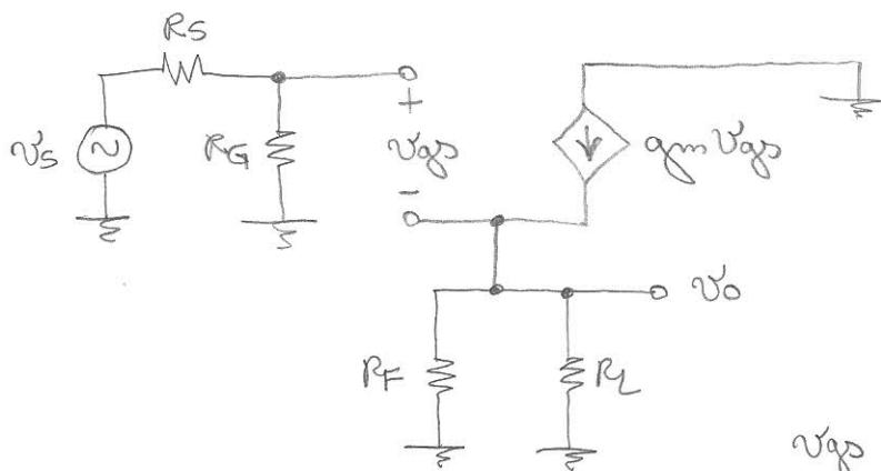
$$V_o = \alpha_m V_{gs} \cdot R_F // R_L \quad (i)$$
