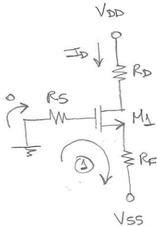
Por superposição, zeramos a fonte de sinal  $V_s$  (substituindo-a por um curto-circuito) e aplicamos apenas as fontes de polarização DC ( $V_{DD}$  e  $V_{SS}$ ).
