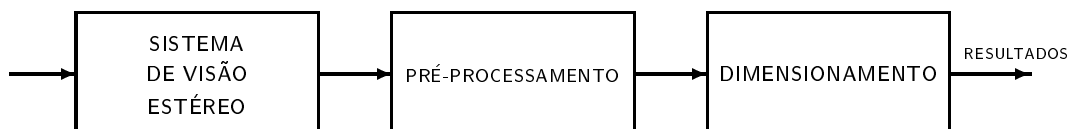
Figura 1.1: Diagrama em blocos do Sistema de Visão Tridimensional.
